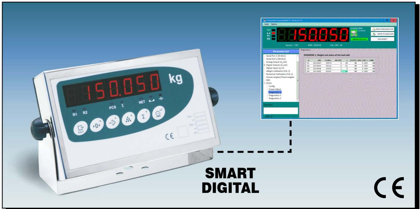
Le SMART DIGITAL est un indicateur de pesage électronique permettant de connecter jusqu'à 16 capteurs de pesage DIGITAUX. Il dispose d'un programme PC avec lequel la balance est configurée et calibrée très facilement, en utilisant l'écran pour afficher l'état de chaque capteur de charge séparément, améliorant ainsi le processus d'installation, d'étalonnage et de maintenance.
