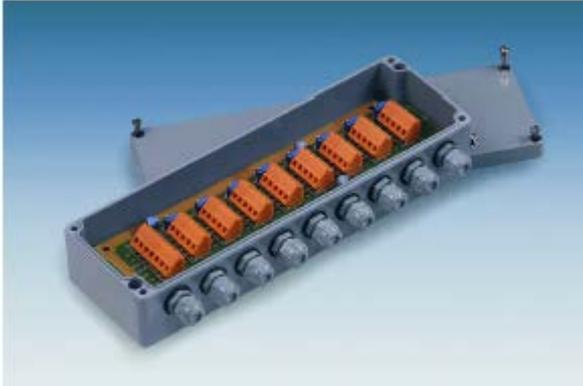
接线盒用于将同一秤的一组称重传感器连接到一个电子显示仪表，以获得各个称重传感器的总信号。当每个角上施加了相同负荷时，内部精密电位计允许进行细调，以均衡从每个支撑点获得的重量读数（角调节）。
