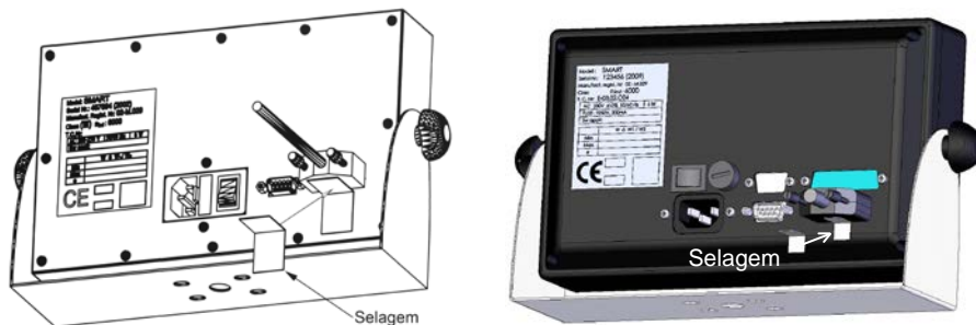
Figura 5.1.1.1 Selagem do conector da célula de carga.
