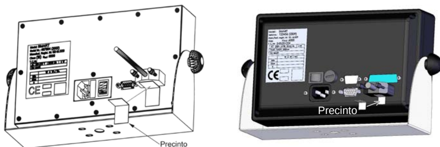
Figura 5.1.1.1 Precintado del conector de célula
