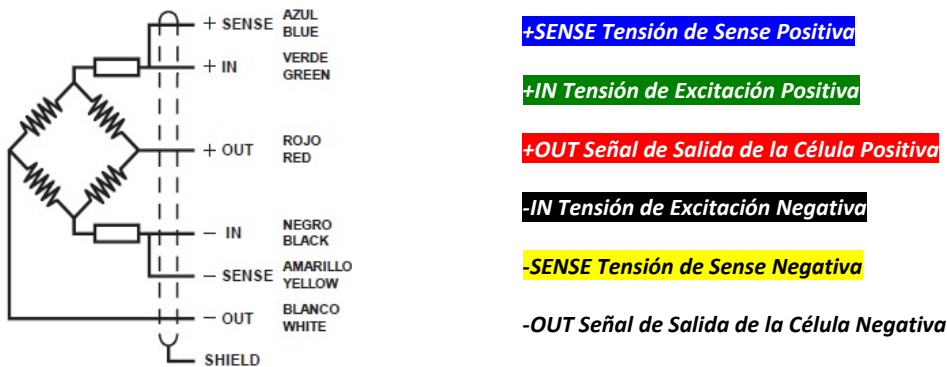
Fig. 4- Codificación de colores de una célula de carga de 6 hilos de UTILCELL
