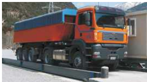
汽车衡 原料和成品的接收，分类和管理
